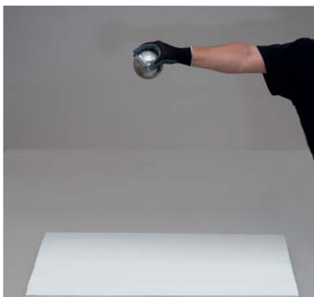
Test pokazujący odporność mechaniczną: uderzenie kulą o wadze 5 kg z wysokości 2 m
