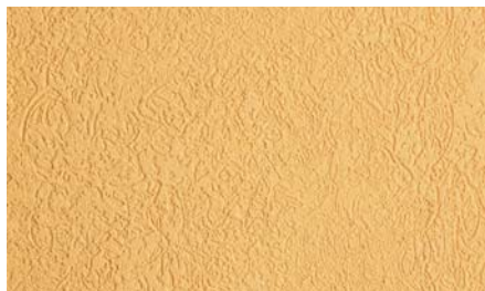
Tynk akrylowy o fakturze „kornik” Ceresit CT 64, o uziarnieniu 2.0 mm, otrzymywany przez okrężne zacieranie pacą
