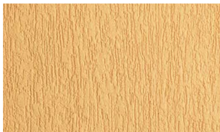
Tynk akrylowy o fakturze „kornik” Ceresit CT 64, o uziarnieniu 2.0 mm, otrzymywany przez zacieranie pacą w jednym kierunku
