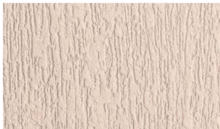
Tynk mineralny o fakturze „kornik” Ceresit CT 35, o uziarnieniu 2.5 mm, otrzymywany przez zacieranie pacą w jednym kierunku
