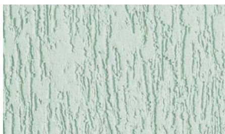
Tynk akrylowy o fakturze „kornik” Ceresit CT 63, o uziarnieniu 3.0 mm, otrzymywany przez zacieranie pacą w jednym kierunku
